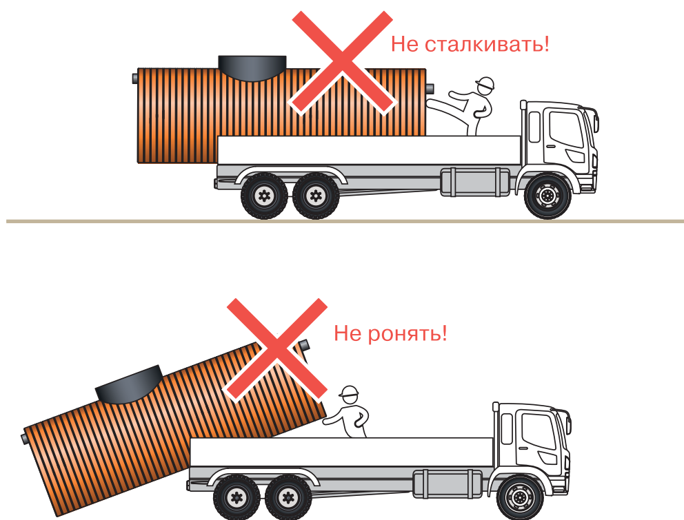
Рис. 5.1. Неправильный пример разгрузки полимерного изделия.
