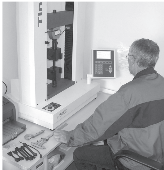
Фото 4.2.8. Испытания стыковых сварных соединений в лаборатории ИКАПЛАСТ
